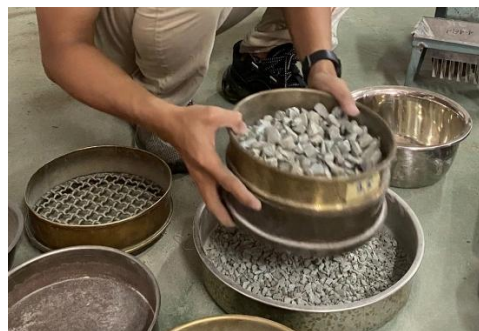
Gambar 6. Proses Penyaringan PET
