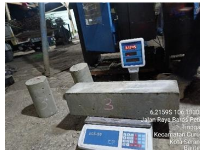
Gambar 10. Beam Beton ditimbang
