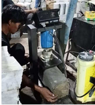
Gambar 11. Meletakkan Beam Beton untuk diuji
