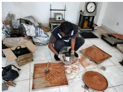
Gambar 1. Proses pengayakan agregat bahan pengganti genteng dan keramik
