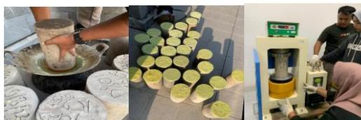
Gambar 2. Proses pengukuran nilai kuat tekan beton
