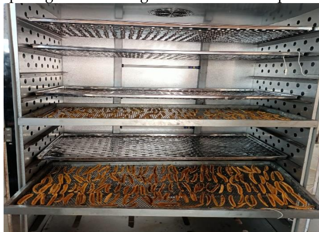
Gambar 4. Proses pengeringan pisang
