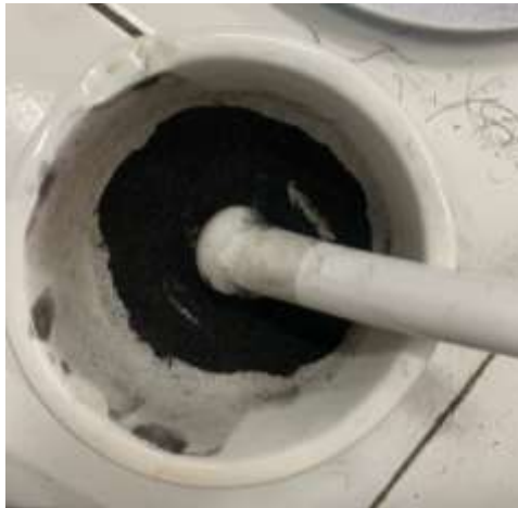
Gambar 4. Proses Penghancuran Karbon Menjadi Pigmen (Sumber: Dokumen Pribadi, 2025)
