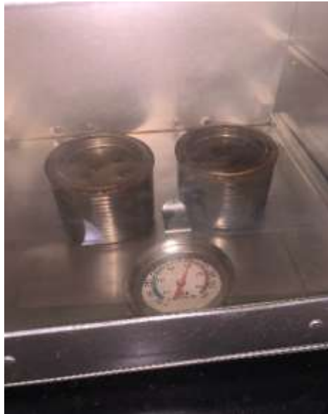
Gambar 2. Proses Pirolisis Sabut Kelapa (Sumber: Dokumen Pribadi, 2025)
