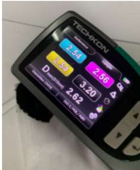
Gambar 10. Pengujian Kepekatan Warna (Sumber: Dokumen Pribadi, 2025)
