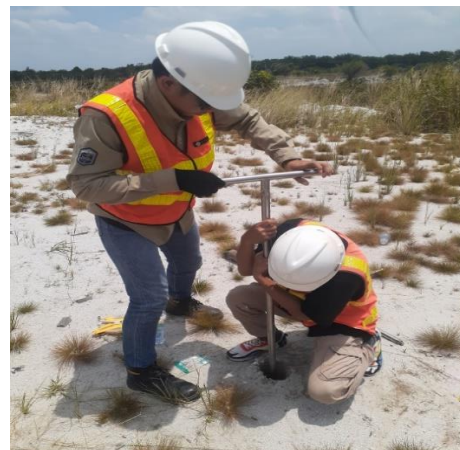
Gambar 6. Pengambilan sampel dengan Hand Auger
