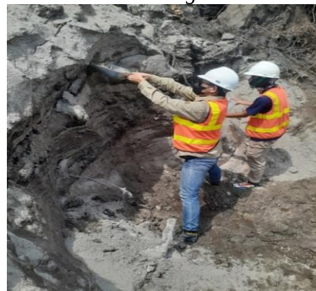
Gambar 7. Pengambilan Sampel dengan teknik Channel Sampling
