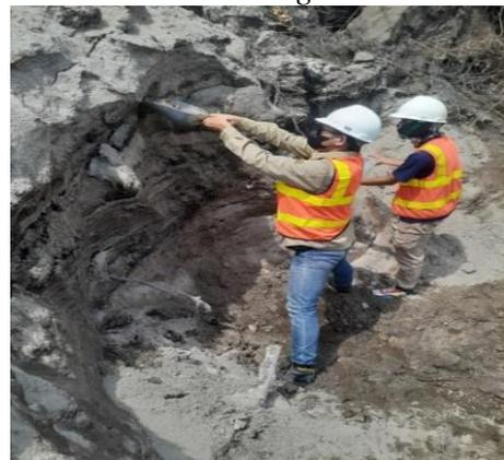
**Gambar 7.** Pengambilan Sampel dengan teknik *Channel Sampling*
