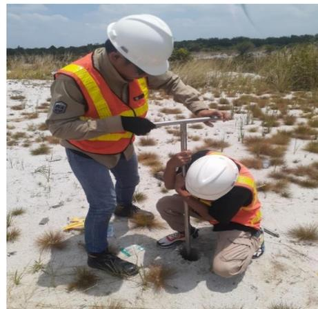
**Gambar 6.** Pengambilan sampel dengan *Hand Auger*
