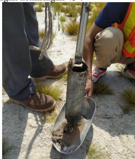
Sumber: Foto Pribadi (dokumentasi penelitian, 2023) Gambar 3. Proses mengeluarkan sampel dari tabung bor hand auger
