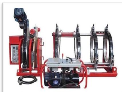
**Gambar 4** Las Tumpul (*Butt Welding*)
