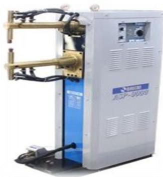
**Gambar 1** Las Titik (*Spot Welding*)
