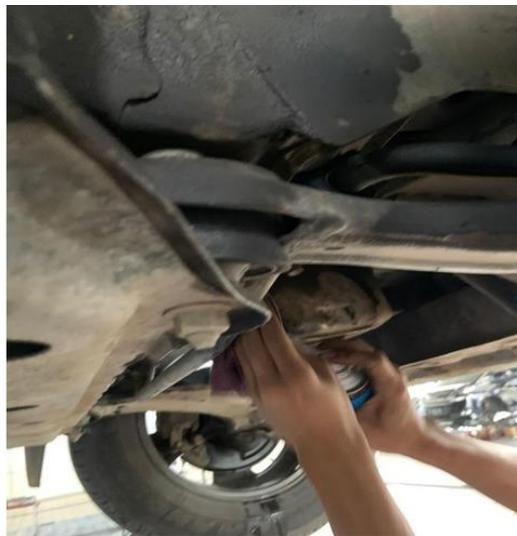
**Gambar 3.** Penggantian brake pads (kampus rem)
