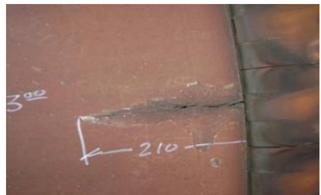
Gambar 4. Retak di bagian Iner Casing Turbin
