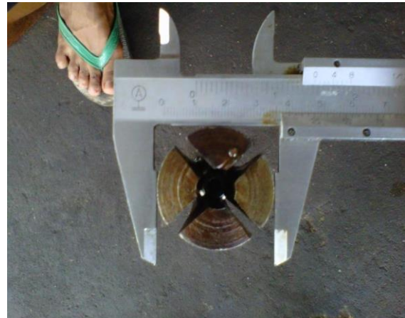
Gambar 9. Mata Alat Pelepas Seal Power Steering pada saat mengembang
