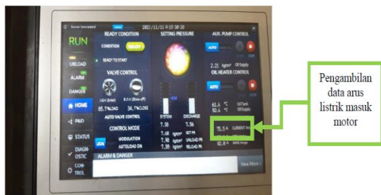
Gambar 9. Pengambilan Data Arus dan Tegangan Listrik Motor
