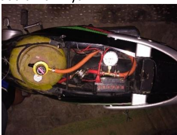
Gambar 6. Pemasangan Tabung Gas
