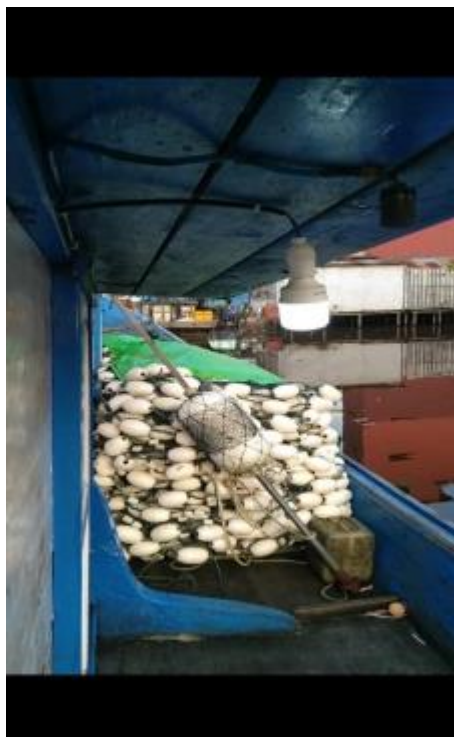
Gambar 9. Posisi Lampu Pada Bagian Samping
