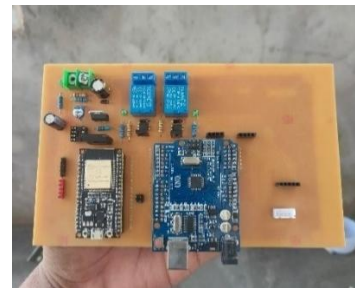
Gambar 13. Tampak PCB Kontrol
