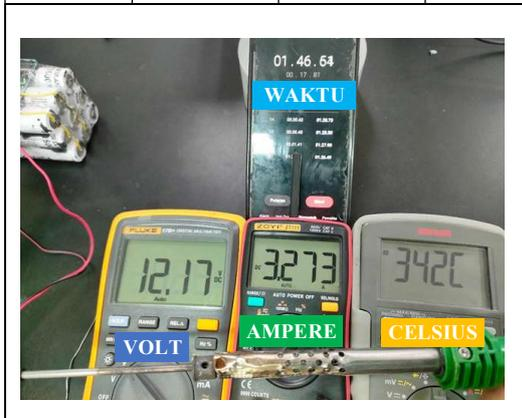
Pada tabel 2. Hasil dari pengukuran berbeban dengan menggunakan alat ukur multimeter Solder DC 12V mendapatkan daya 39,83Watt dihitung dengan rumus  $P = V.I$  Dengan tegangan 12,17v setelah diberi beban dan arus beban elemen sebesar 3,273A dengan resistansi yang dihasilkan 3,7Ω, dihitung dengan rumus  $R = \frac{V}{I}$  dengan waktu titik leleh timah 106 Detik dengan suhu yang dihasilkan sebesar 342°C. Dalam pengujian ini arus yang dihasilkan mendekati hasil rumus yang sudah di tentukan
