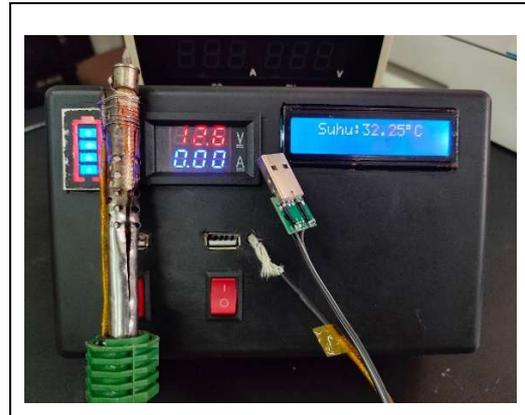
Pada tabel 3. kondisi dimana saklar masih terbuka ( off) tidak ada arus yang masuk kebeban Solder dengan tegangan full 12,6V tanpa beban dan tidak ada pengurangan tegangan akibat arus yang masuk ke beban
