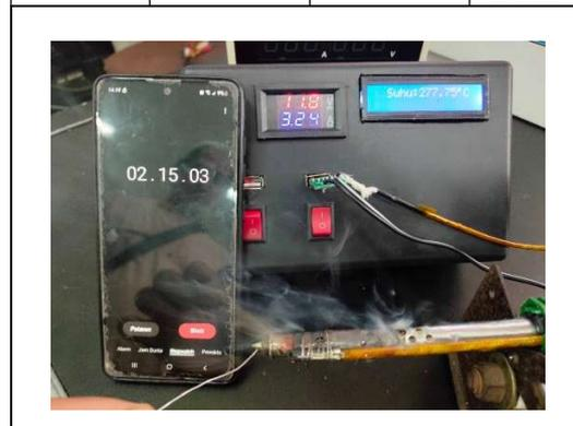
Pada tabel 4. Solder DC 12V mendapatkan daya 38,23Watt dihitung dengan rumus  $P = V.I$  Dengan tegangan 11,8v setelah diberi beban dan arus beban elemen sebesar 3,24A dengan resistansi yang dihasilkan 3,6Ω, dihitung dengan rumus  $R = \frac{V}{I}$  dengan waktu titik leleh timah 135 Detik dengan suhu yang dihasilkan sebesar 277°C.
