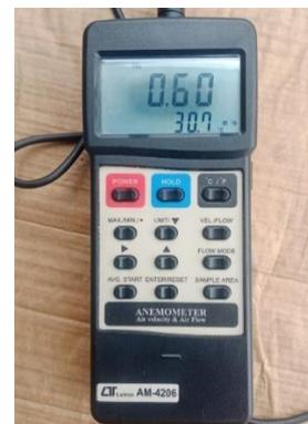
Gambar 15. Pengukuran Suhu Pada Alat Ukur annemometer
