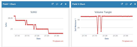
Gambar 11. Hasil data dari Sensor Dht22 dan Ultrasonik
