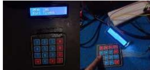
Gambar 12. Pengujian LCD dan Keypad
