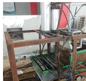
Gambar 3.1 Implementasi Desain Cetakan Batako
