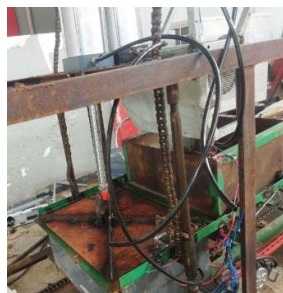
Gambar 3.2 Implementasi Desain Pengepres Campuran Batako Gambar 3.2 menggambarkan implementasi sistem pneumatik sebagai media penekan
