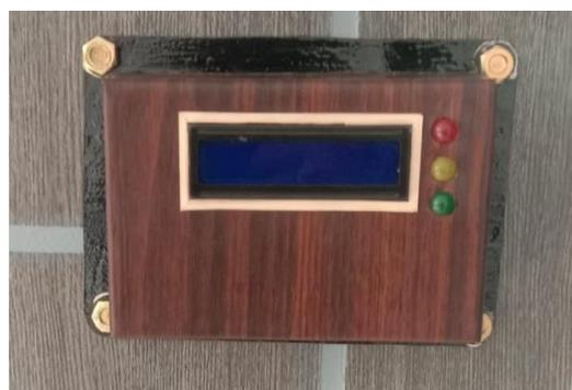
Gambar 3.1 Alat Fisik Hardware Kunci Pintu RFID
