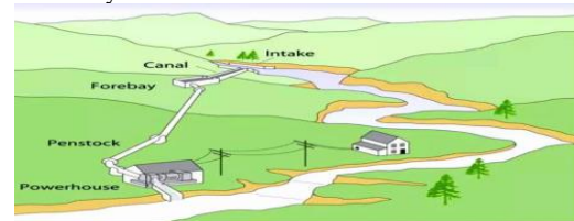
Gambar 1. Skema PLTMH secara umum
