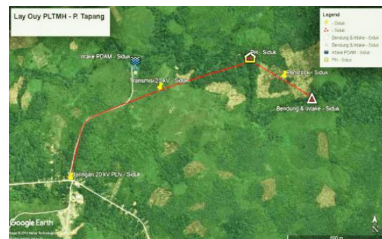
Gambar 7. Lay-out PLTMH Siduk
