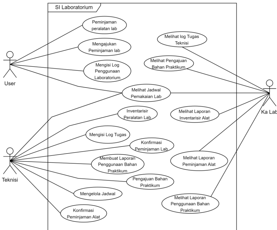
Gambar 2. Use case sistem informasi laboratorium
